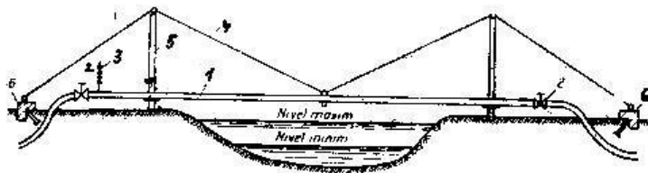
Schema traversării aeriene a unei conducte pentru transportul gazelor naturale
